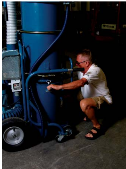
Behållaren sätts fast på maskinen med hjälp av de båda spännlås.
