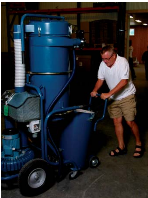
Vid tömning lossas behållaren och dras bort från maskinen. Sedan kan platsäcken tas ut.
