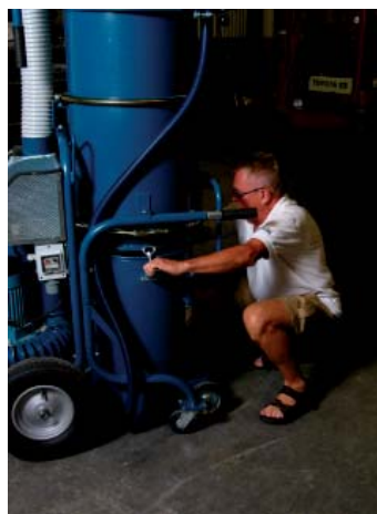
Der Behälter wird an der Maschine mit Hilfe der beiden Spannschlösser befestigt.
