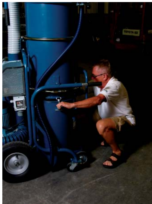
Behållaren sätts fast på maskinen med hjälp av de båda spännlåsena.
