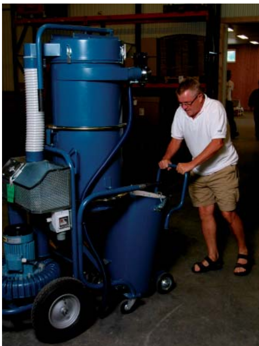
Vid tömning lossas behållaren och dras bort från maskinen. Sedan kan plasticsäcken tas ut.
