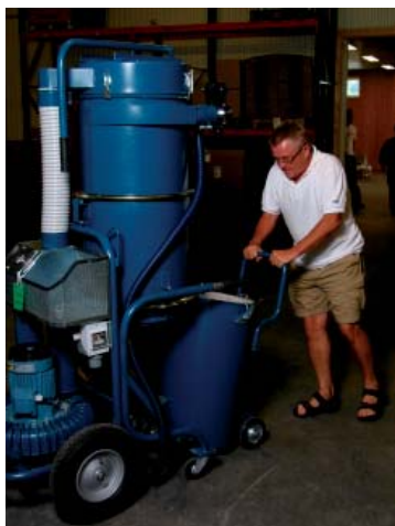
Bei Entleerung wird der Behälter von der Maschine entfernt. Danach kann der Plastiksack herausgenommen werden.
